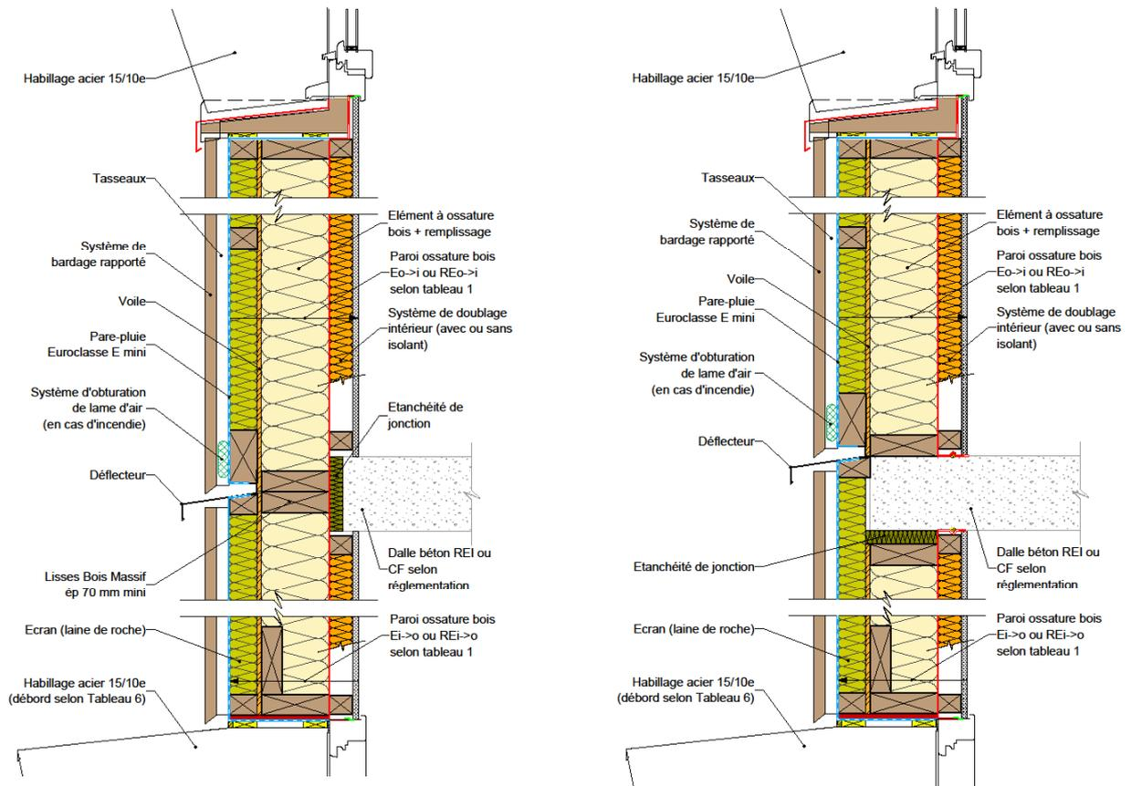
Figure 27 : Façade/mur ossature bois & plancher en béton.
