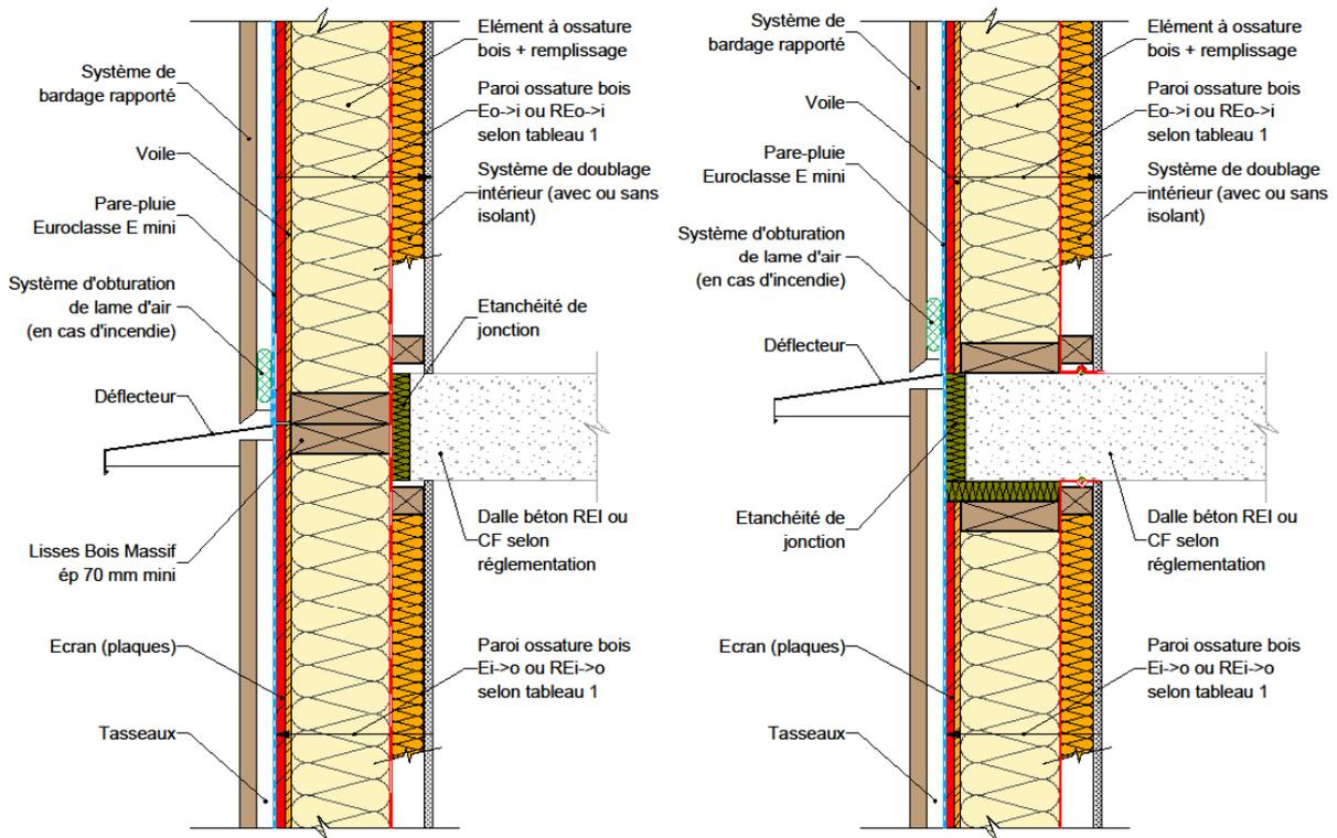
Figure 15 : Façade en ossature bois sur plancher béton.
